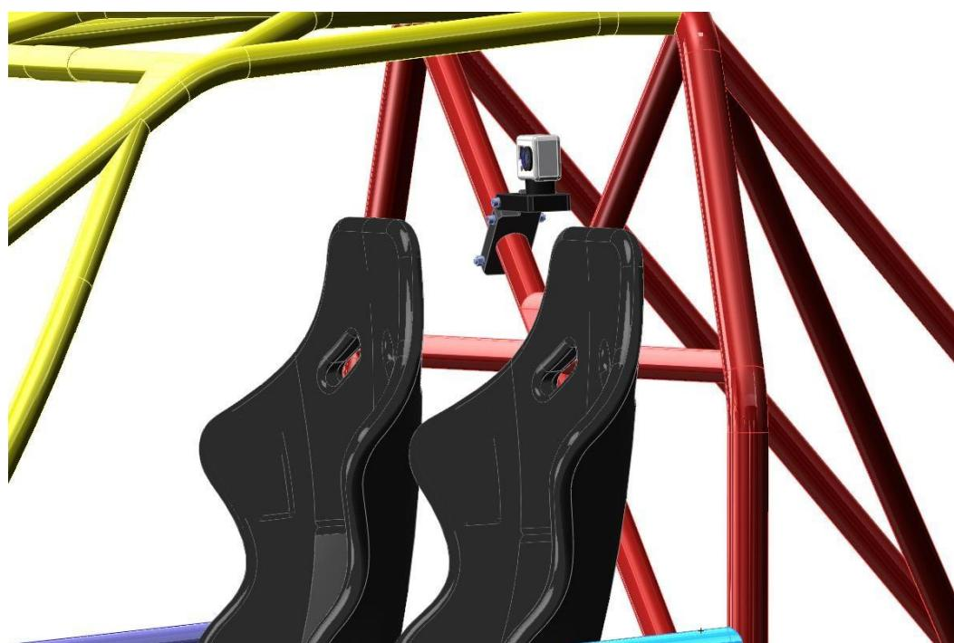
Pour les caméras de type « Crayon » **ou les boîtiers de captures vidéos**, elles **ils** pourront être fixées sur le montant de l'arceau avant et le boîtier devra être fixé sur le plancher (idem fixation batterie) derrière les sièges.
